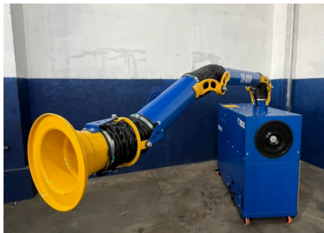
Unidade completa com braço estendido — descarga de ar filtrado na lateral do gabinete.
