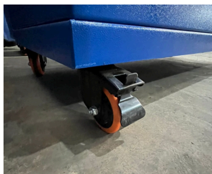
Rodízios com trava — deslocamento entre postos sem ferramenta.
