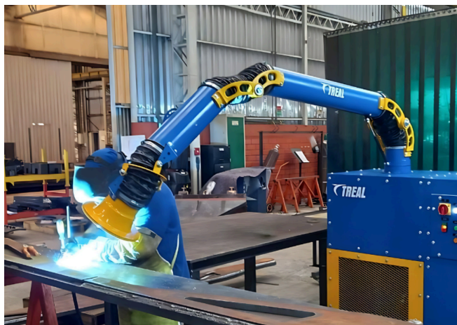
Captação na fonte durante solda de estrutura — o braço acompanha a posição do soldador.
